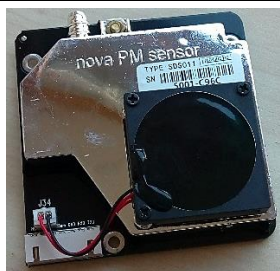
Capteur de particules fines : SDS011
